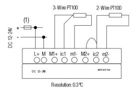
Figure 22 Analogue PT100 2-, 3-Wire Inputs
